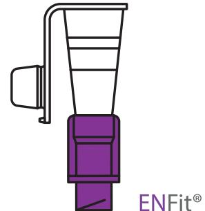
**Connettori più Sicuri:** L'adattatore Compat® Adapter Set con connettore multiconico > Sonda ENFit® comprende un connettore ENFit® realizzato in conformità allo standard ISO 80369-3. I connettori ENFit® sono studiati per non essere compatibili con i set per infusione endovenosa al fine di tutelare la sicurezza del paziente aiutando a evitare involontari collegamenti sbagliati.
